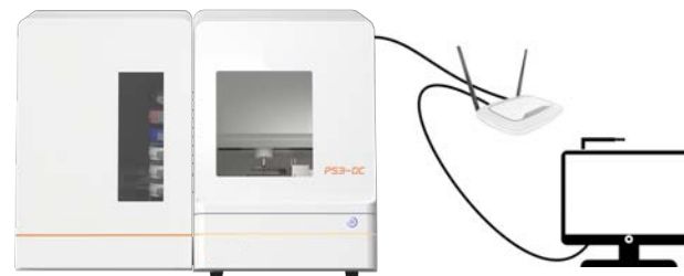
PS: сценарий использования, при котором один ПК управляет несколькими станками
