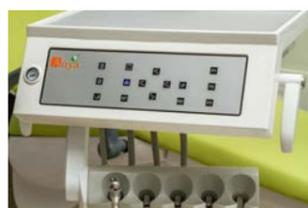
Сенсорная панель на модуле врача. Три программируемых положения. Управление плевательницей, подогревом воды, наполнением стакана.
