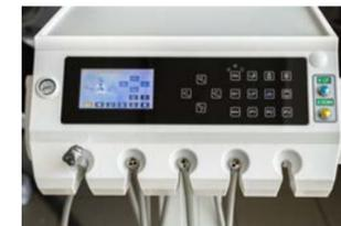
Подкатной модуль врача с регулировкой положения по высоте. Сенсорная панель из ударопрочного стекла. 5 инструментов
