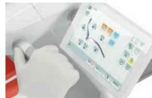
Стоматолог может легко настраивать функции установки, задавать параметры всех интегрированных устройств, управлять движениями кресла и гигиеническими устройствами благодаря 7" сенсорному экрану. Данные терапии, эндодонтии и имплантации отображаются в реальном времени. Панель управления Full Touch Multimedia также выводит изображения и видео.
